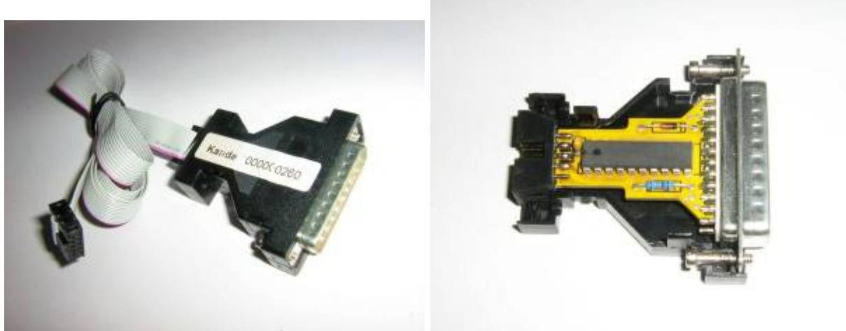
Dieser AVR-Progammieradapter (Bj 1998) wird am Parallelport angeschlossen. Er enthält lediglich einen 74HC244-Treiber-IC, die Programmierlogik übernimmt vollständig der PC. s.a.
