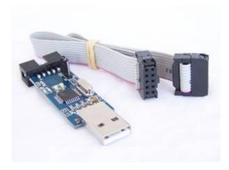
Bei ebay gibt es für wenig Euro USBASP-kompatible Programmierer. Ich hatte mir eine Version namens "USBASP V2.0 Lcsoft Studio" gekauft. Bei Protostack findet man ein komplettes Userguide mit allen benötigten Unterlagen zu diesem Programmer (AC-PG-USBASP-UG-V2.0).pdf, s.u.).
