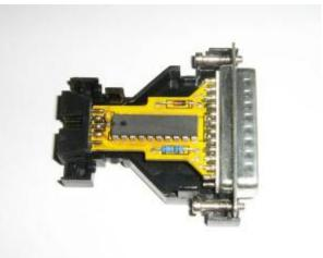
Dieser AVR-Progammieradapter (Bj 1998) wird am Parallelport angeschlossen. Er enthält lediglich einen 74HC244-Treiber-IC, die Programmierlogik übernimmt vollständig der PC. s.a. http://www.mikrocontroller.net/articles/STK200.
