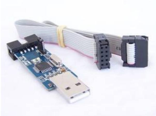
Bei ebay gibt es für wenig Euro USBASP-kompatible Programmierer. Ich hatte mir eine Version namens „USBASP V2.0 Lcsoft Studio“ gekauft. Bei Protostack findet man ein komplettes Userguide mit allen benötigten Unterlagen zu diesem Programmierer
