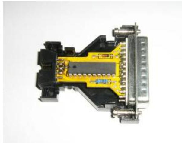
Dieser AVR-Progammieradapter (Bj 1998) wird am Parallelport angeschlossen. Er enthält lediglich einen 74HC244-Treiber-IC, die Programmierlogik übernimmt vollständig der PC. s.a.
