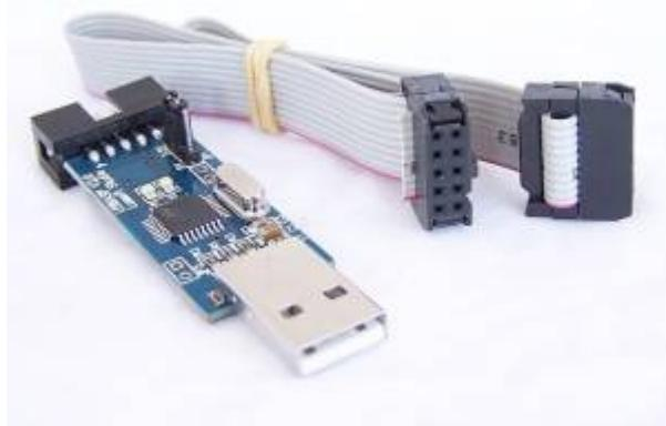
Ich hatte mir eine Version namens „USBASP V2.0 Lcsoft Studio“ gekauft. Bei Protostack findet man ein komplettes Userguide mit allen benötigten Unterlagen zu diesem Programmer (AC-PG-USBASP-UG-V2.0.pdf, s.u.).
