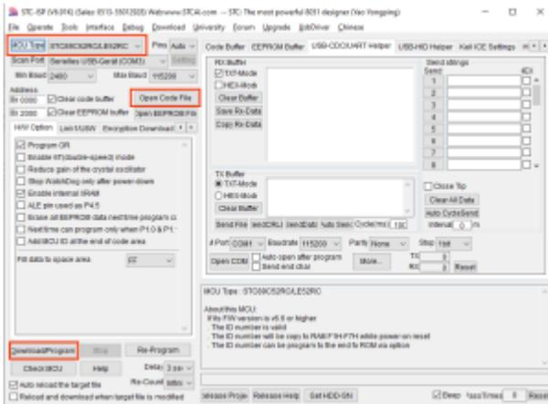
1. Als MCU-Typ muss der korrekte Typ ausgewählt werden, hier also „STC89C52RC/LE52RC“.
