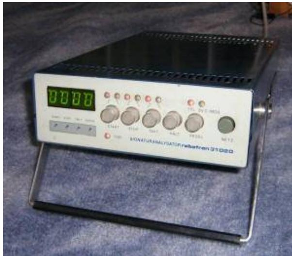
Ein Signaturanalysator analysiert ein digitales Signal, indem über einen definierten Zeitraum über das Signal eine CRC-Summe (= Signatur) berechnet wird. Anfang und Ende des Zeitraums werden dem Gerät über zwei Eingänge signalisiert. Stimmt die angezeigte CRC mit der im Signaturplan hinterlegten überein, ist mit hoher Wahrscheinlichkeit die Leitung in Ordnung.
