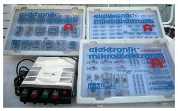
Im ersten Kasten sind die Elektrik-Bauteile, also Relais, Motor usw. Im 2. Kasten div. Bauelemente (sogar Led!) und im 3. Kasten sind die "Module" wie Zähler, Taktgeber, NF-Verstärker, OPV etc. Dazu gab es ein großes und robustes Netzteil. Unter den Platten mit den Bauteilen befindet sich weiteres Zubehör wie Kabel, Lautsprecher, usw.
