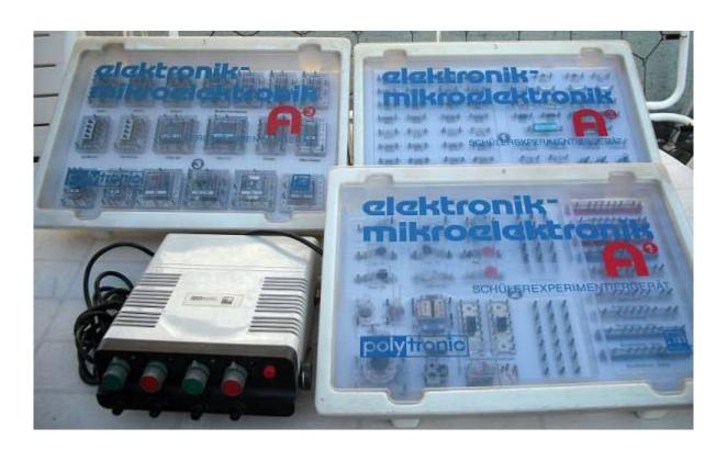
Im ersten Kasten sind die Elektrik-Bauteile, also Relais, Motor usw. Im 2. Kasten div. Bauelemente (sogar Led!) und im 3. Kasten sind die "Module" wie Zähler, Taktgeber, NF-Verstärker, OPV etc. Dazu gab es ein großes und robustes Netzteil. Unter den Platten mit den Bauteilen befindet sich weiteres
