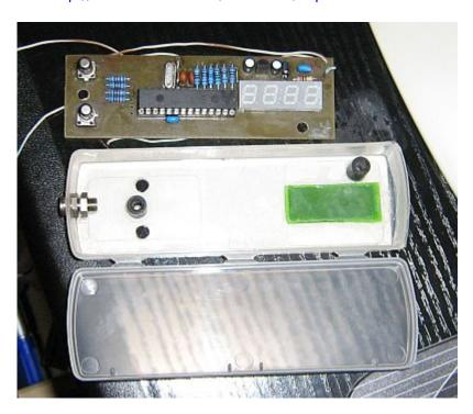
Am längsten hat der "Bau" des Gehäuses gedauert. Da die DIL-Version für meine Kabelschächte zu breit war, habe ich die Plaste-Verpackung für Fahrradschlauchflickzeug zweckentfremdet. Die Größe ist optimal! Die Leiterplatte wird an zwei eingeklebten Abstandsstücken festgeschraubt. Die Tasten 1
