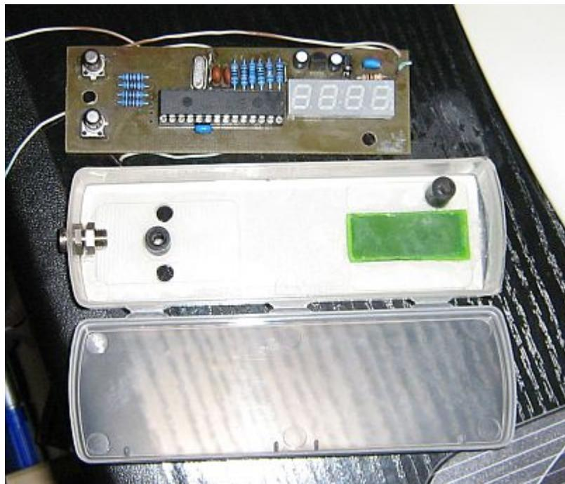
Am längsten hat der „Bau“ des Gehäuses gedauert. Da die DIL-Version für meine Kabelschächte zu breit war, habe ich die Plaste-Verpackung für Fahrradschlauchflickzeug zweckentfremdet. Die Größe ist optimal! Die Leiterplatte wird an zwei eingeklebten Abstandsstücken festgeschraubt. Die Tasten 1 und 2 sind einfach alte Germaniumtransistoren (ohne Beine, auf die kleinen Schalter aufgeklebt). Die
