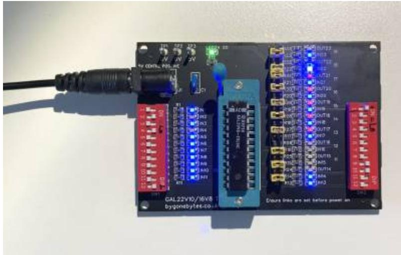
Das Board hat einen ZIF-Sockel, LEDs für alle Input & Output Pins und Schalter für jeden Eingang.
