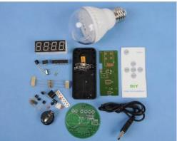
Der Bausatz enthält alle Teile incl. Knopfzellen! Achtung: Es müssen auch mehrere SMS-Bauteile gelötet werden!
