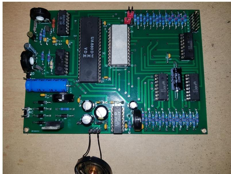
Mikrorechner-Akustik-Set, VEB Mikroelektronik Erfurt, 1987
