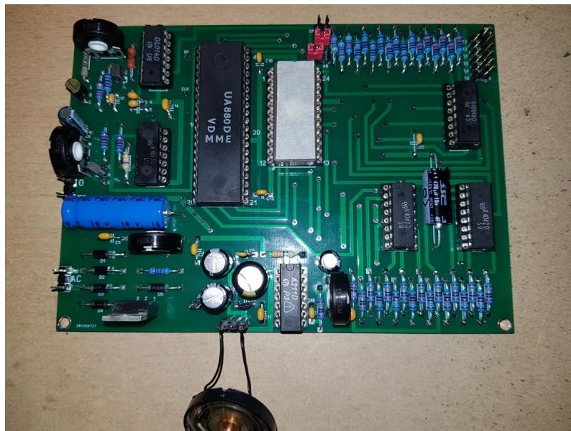
Mikrorechner-Akustik-Set, VEB Mikroelektronik Erfurt, 1987
