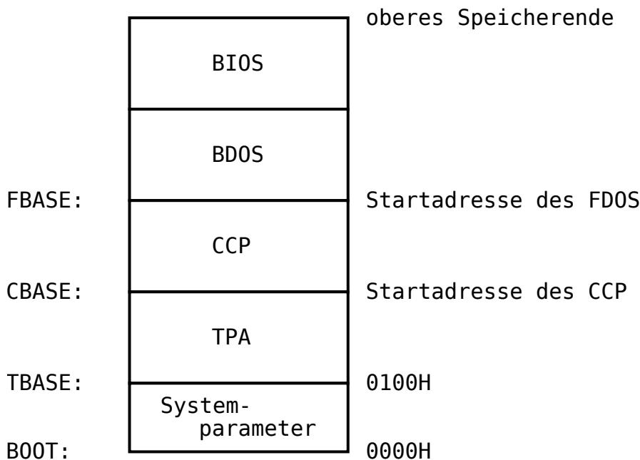
An der Adresse BOOT befindet sich grundsätzlich ein Sprung zur Warmstartroutine des BIOS. Diese Routine lädt nach Beendigung eines Programms den CCP und das BDOS neu in den Speicher und startet danach wieder den CCP. Das Sprungziel ist immer der zweite Eintrag in der BIOS-Sprungtabelle, also BIOS + 0003H.
