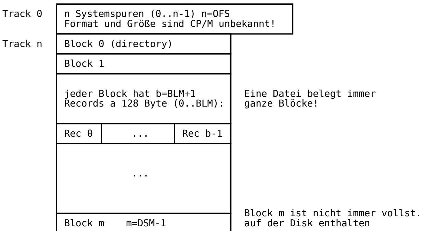
CP/M rechnet Blocknummer + laufende Rec-Nummer in Track und 128-Byte-Sector um.
