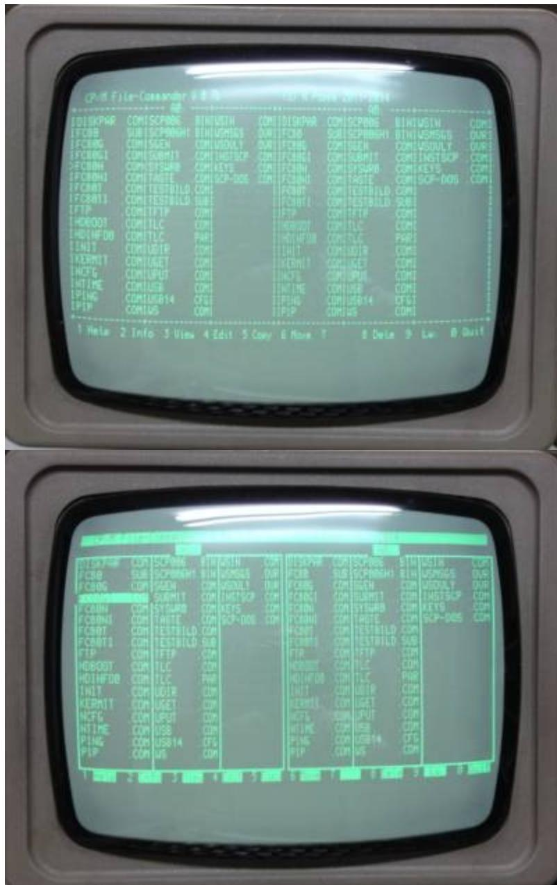
Voraussetzung für das Programm ist ein CP/M 2.2 oder 3.0 und ein BWS mit 64 Zeichen und 32 Zeilen (FC64.COM) oder mit 80 Zeichen und 24 Zeilen (FC80.COM). Optional wird eine [USB-VDIP-Anbindung nach M.Leubner](#) direkt unterstützt, ein Kopieren von/aus USB ist damit direkt möglich. Ab Version 0.97 wird der IO-USB vom NKC ebenfalls unterstützt.
