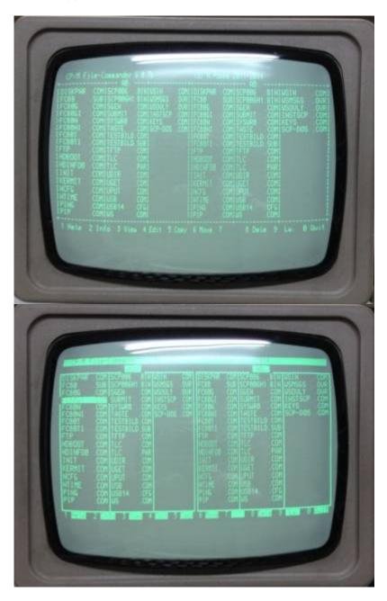
Voraussetzung für das Programm ist ein CP/M 2.2 oder 3.0 und ein BWS mit 64 Zeichen und 32 Zeilen (FC64.COM) oder mit 80 Zeichen und 24 Zeilen (FC80.COM). Optional wird eine USB-VDIP-Anbindung nach M.Leubner direkt unterstützt, ein Kopieren von/aus USB ist damit direkt möglich.
