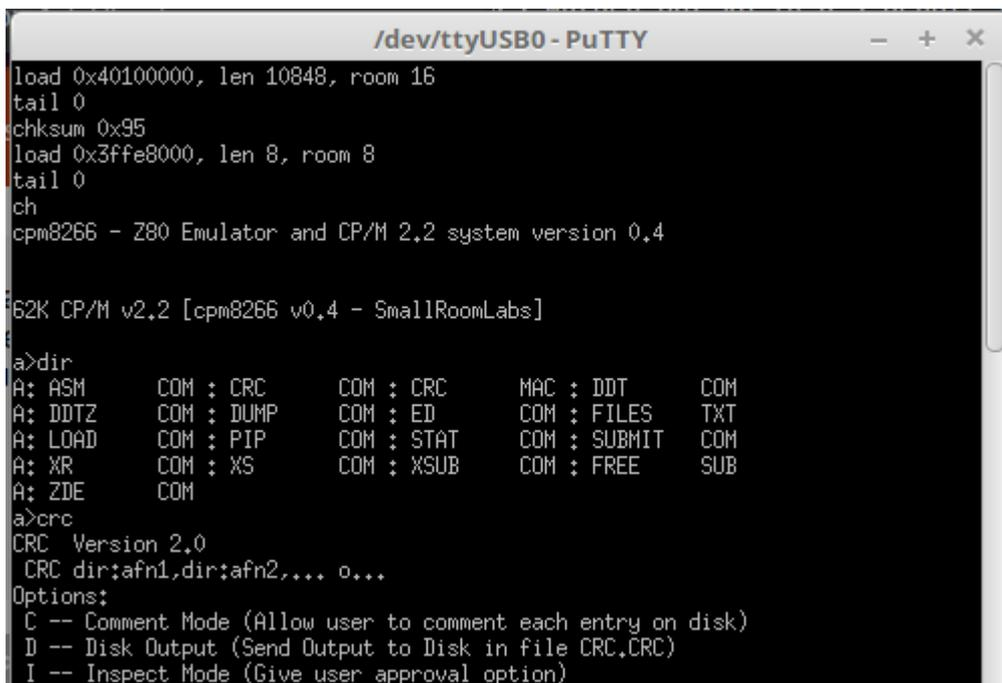
Nach Reset muss 2x Enter gedrückt werden. Die Baudrate wird dadurch automatisch erkannt. Es sind Werte von 115200 bis hinunter zu 300 Baud möglich (s. AutoBaud() in uart.c).
