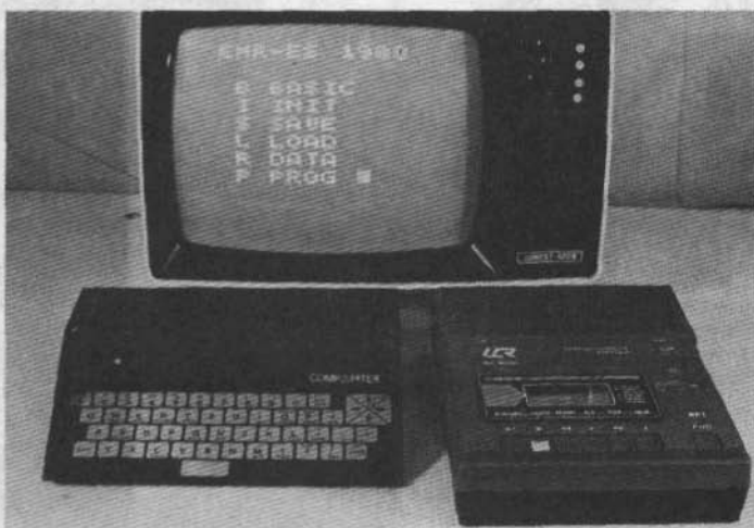
Grundgerät mit Folien-Flachta- statur und Standard-Peripherie
