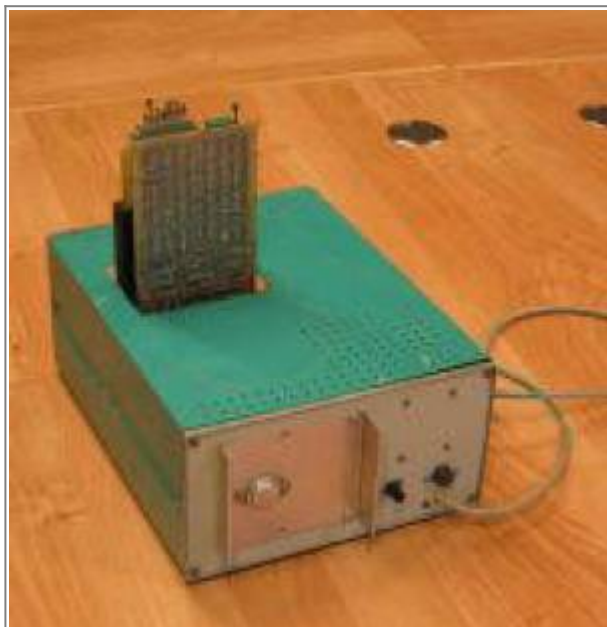
Der Z1013 von hinten mit aufgesteckter 256K-Nanos-RAM-Floppy und Eprommer .
