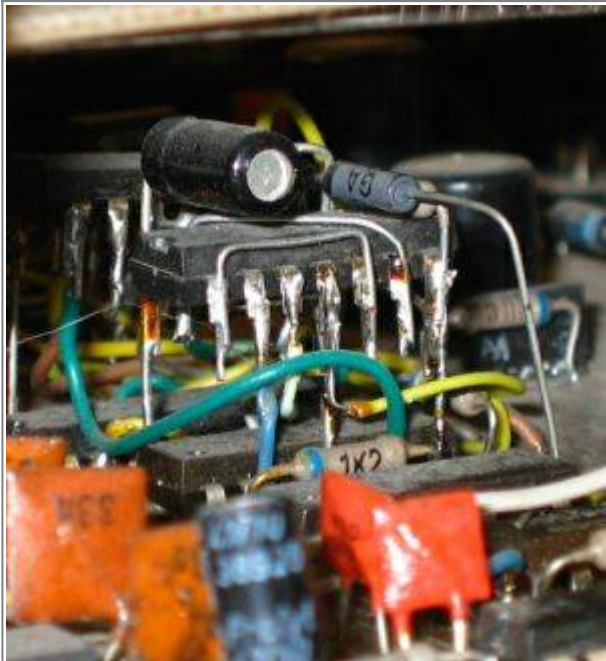
Das müsste die erweiterte Resetlogik ein, im üblichen Huckepackverfahren realisiert.
